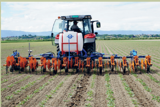
Neue Hackgeräte können dank GPS- und Kameraunterstützung von einer Person bedient werden und erreichen hohe Flächenleistungen bei hoher Präzision.
